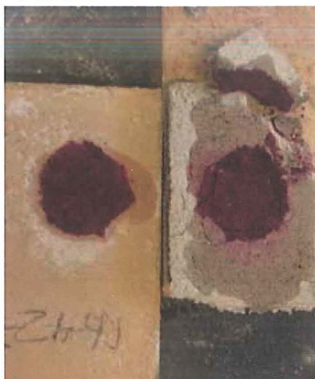
Figur 9. Karbonatiseringsdybde i prøverne blev målt efter brud ved påsprøjtningen af indikatoren phenolphthalein
