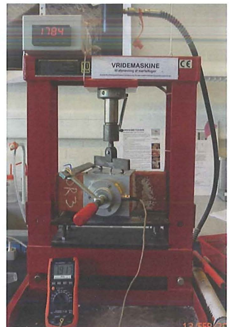
Figur 4. På DTU - BYG er en prototype af en forholdsvis enkel, transportabel 'vridemaskine' udviklet. Det er tanken, at maskinen skal kunne anvendes på mørtel- eller teglværker, så det kan vurderes, om en mørtel passer sammen med en given sten 1)
